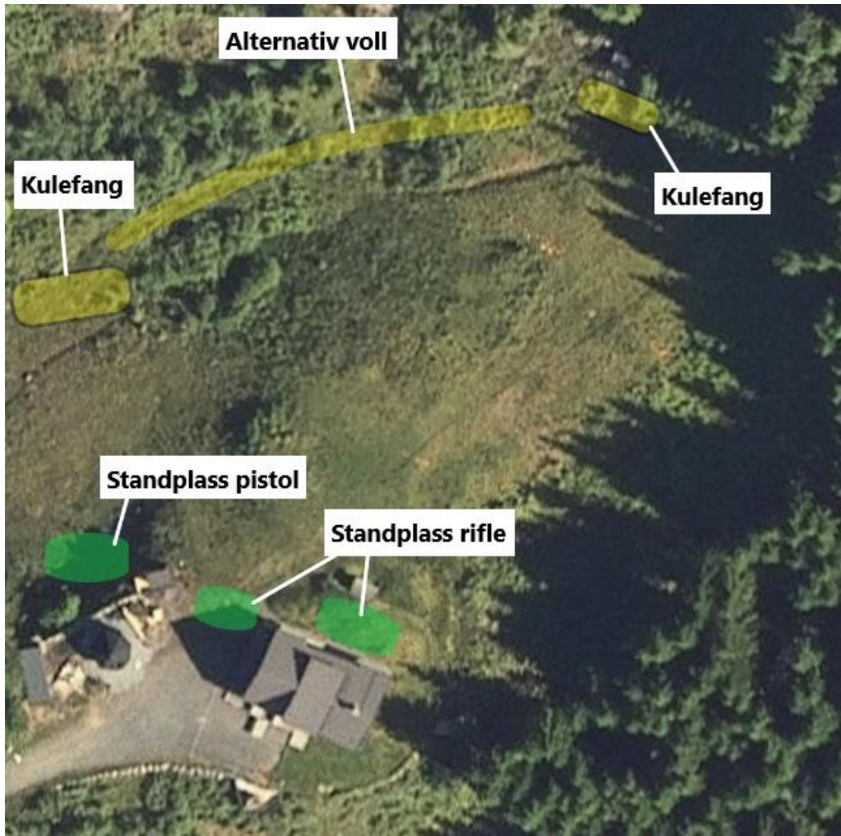
Fig 2. Skissa syner standplassar og kulefang for rifle- og pistolskyting, alternativt ein lenger voll som kulefang.
